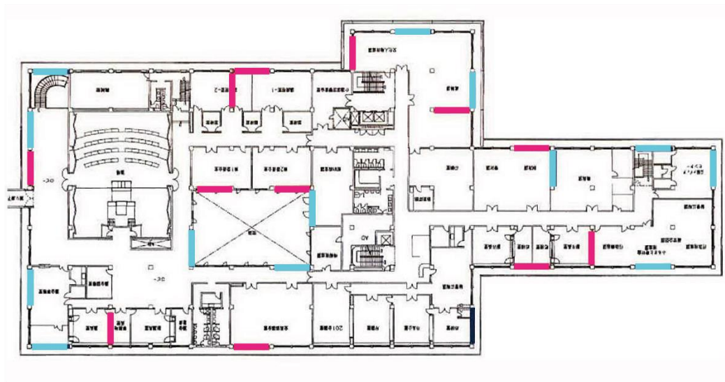
図表 3-3 2階ブレース位置プロット図
