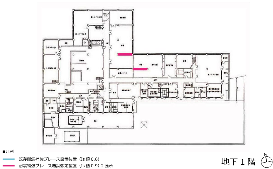
図表 3-2 1階ブレース位置プロット図
