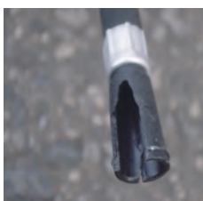
× ノズルの破損
