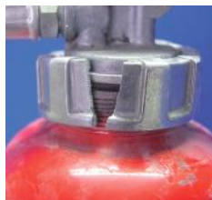
× キャップの破損
