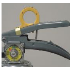
× レバー支えの脱落
