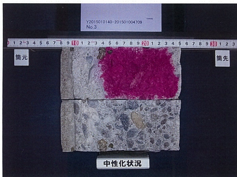
写真-6 中性化状況 (No. 3)
