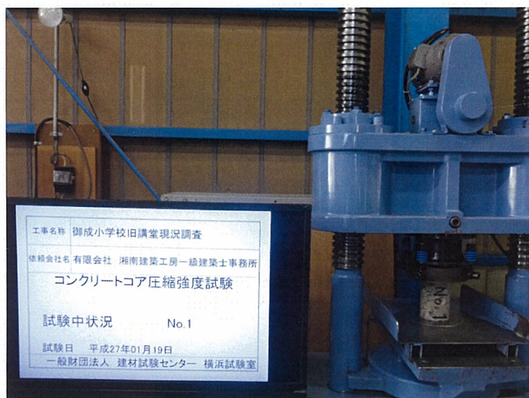
写真－2 圧縮強度試験中状況
