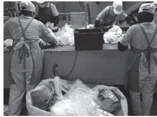
鎌倉市で回収した容器包装プラスチックは、全て(株)テクノ・トランスに集められていて、その全てを手作業で選別し異物を取り除いているんだって！大変だ！
