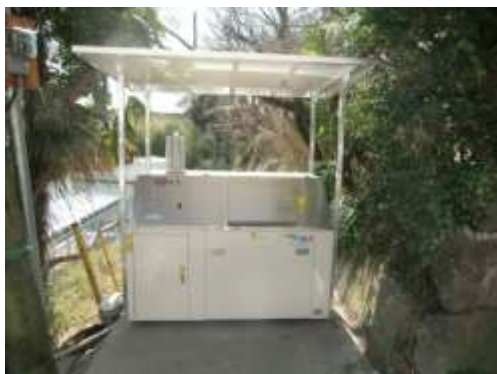
写真 6-1 西御門自治会の大型生ごみ処理機
