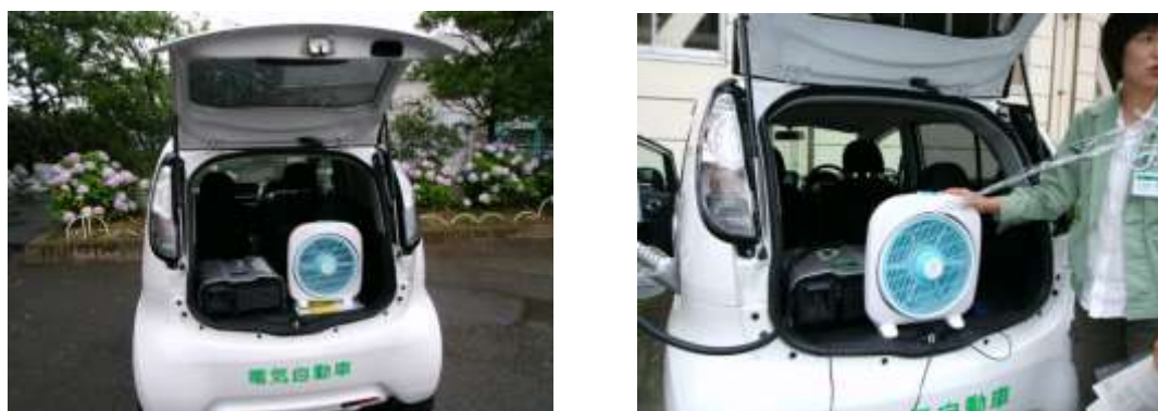
写真 6-2 電気自動車からの電気供給の様子
