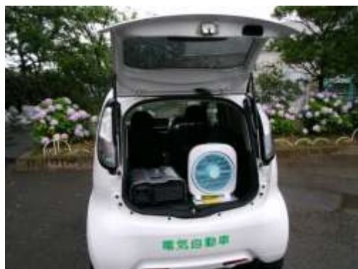
写真6-2 電気自動車からの電気供給の様子
