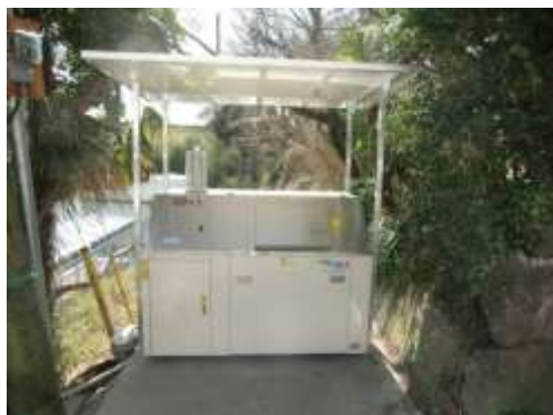
写真6-1 西御門自治会の大型生ごみ処理機
