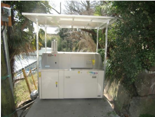
写真6-1 西御門自治会の大型生ごみ処理機
