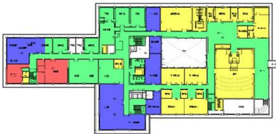
2階 発電機電源供給図
