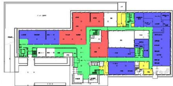
1階 発電機電源供給図
