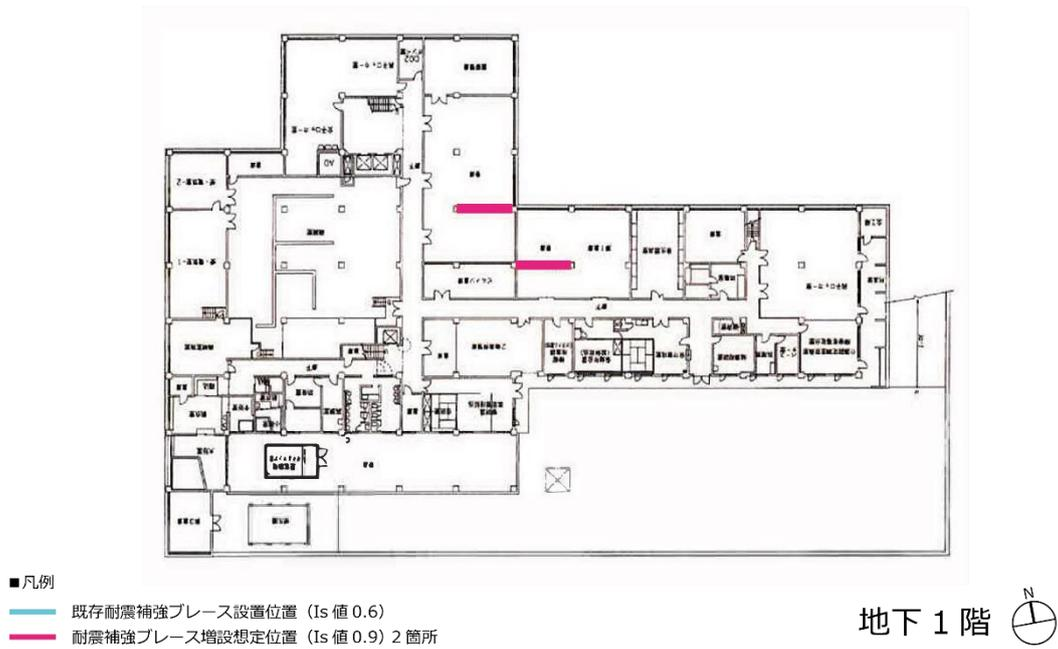
図表 3-2 1階ブレース位置プロット図
