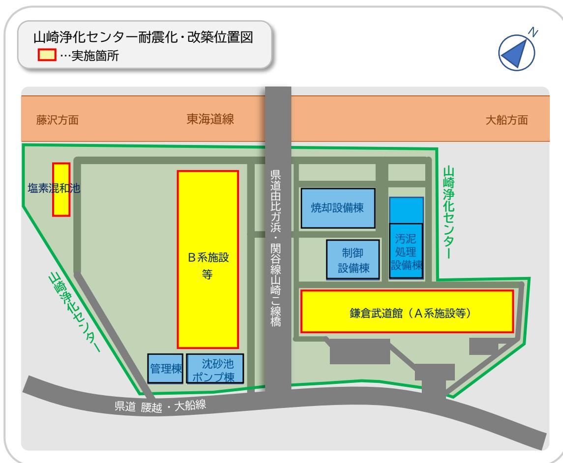
山崎下水道終末処理場の建築物は、いずれも新耐震基準で設計していますが、平成8年度(1996年度)に制定された官庁施設の総合耐震診断・改修基準に基づいた耐震診断を行った結果、耐震性能を満足しない事がわかりました。計画より2年延長し、令和6年度(2024年度)も引き続き、A系水処理設備について耐震診断を行い、令和7年度(2025年度)以降は必要に応じてレベル2地震動時の静的非線形解析を実施し、補強箇所の削減に努めます。
