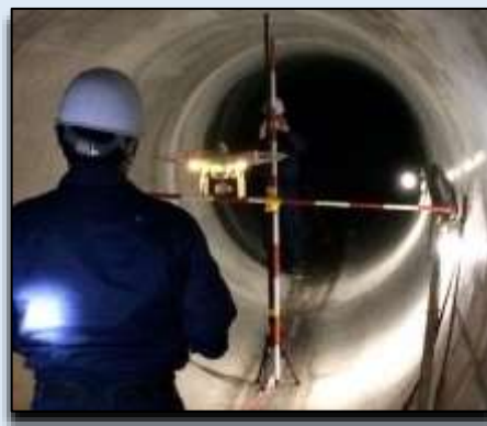
<参考>調査イメージ：潜行目視調査、ドローンによるテレビカメラ調査
