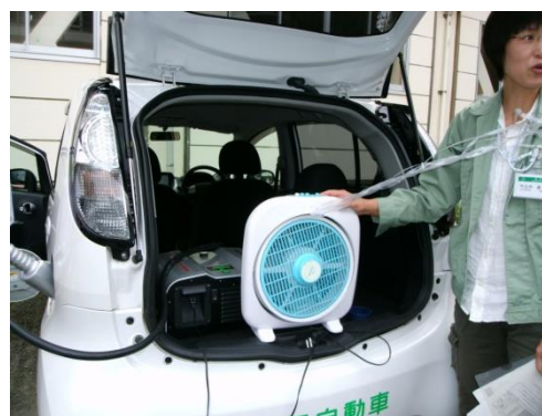
写真 6-1 電気自動車からの電気供給
