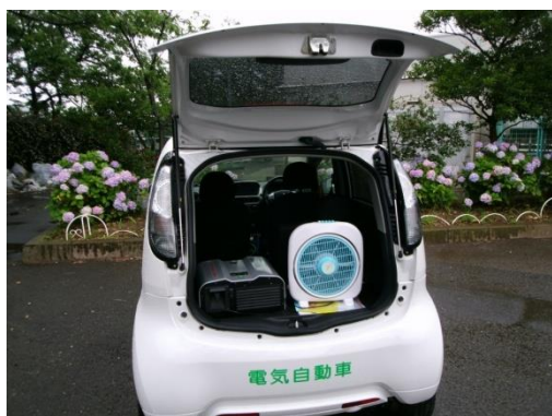
写真 6-1 電気自動車からの電気供給
