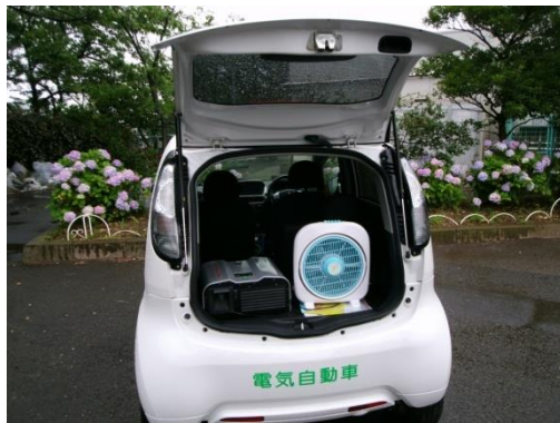
写真6-1 電気自動車からの電気供給
