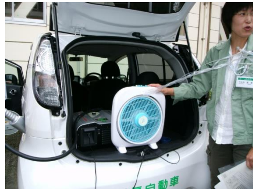
写真6-1 電気自動車からの電気供給
