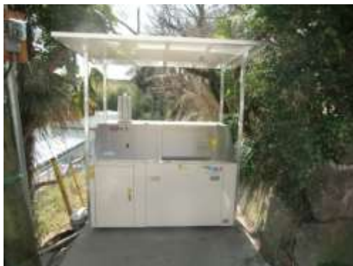
写真 6-1 西御門自治会の大型生ごみ処理機
