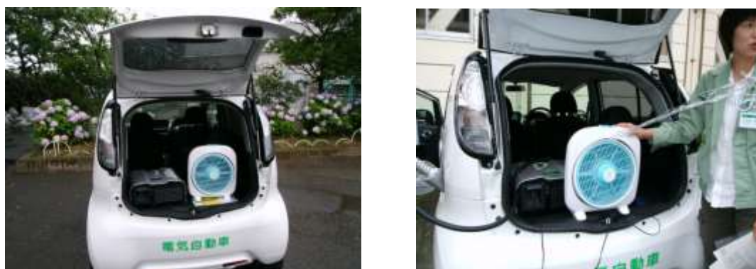
写真 6-2 電気自動車からの電気供給の様子
