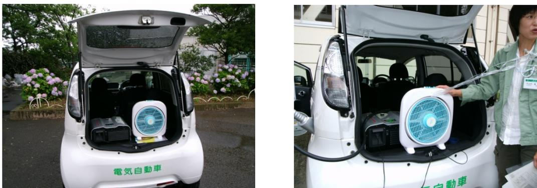
写真 6-2 電気自動車からの電気供給の様子
