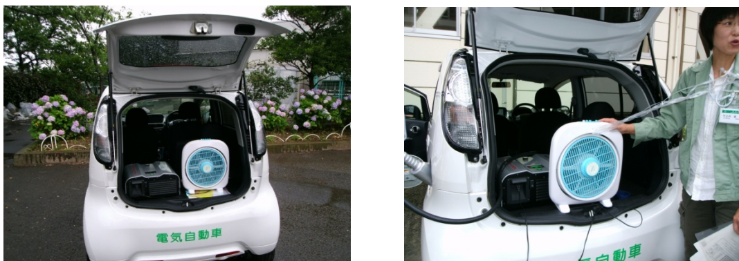
写真 6-2 電気自動車からの電気供給の様子
