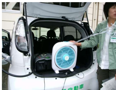
写真6-1 電気自動車からの電気供給
