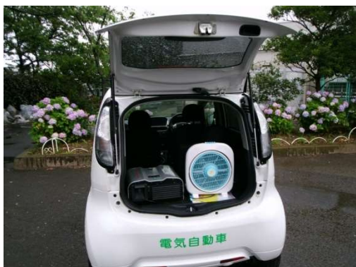
写真6-1 電気自動車からの電気供給
