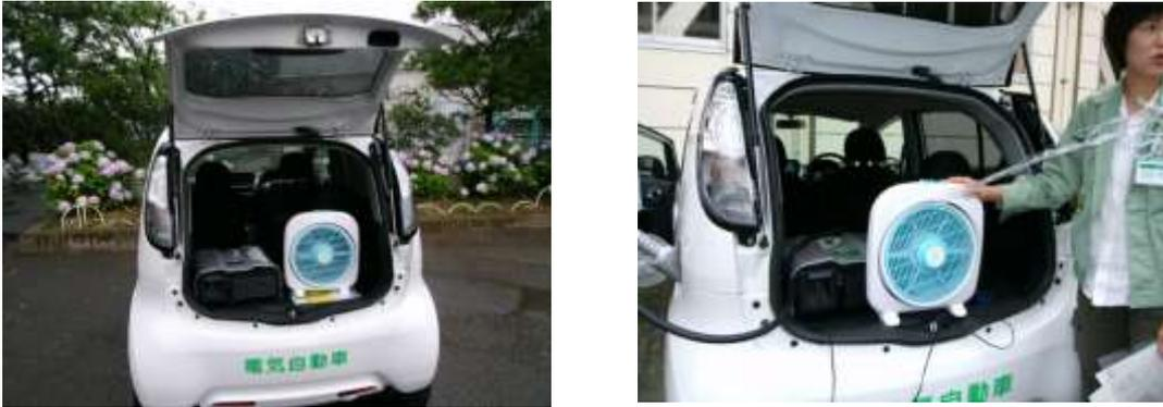
写真6-1 電気自動車からの電気供給
