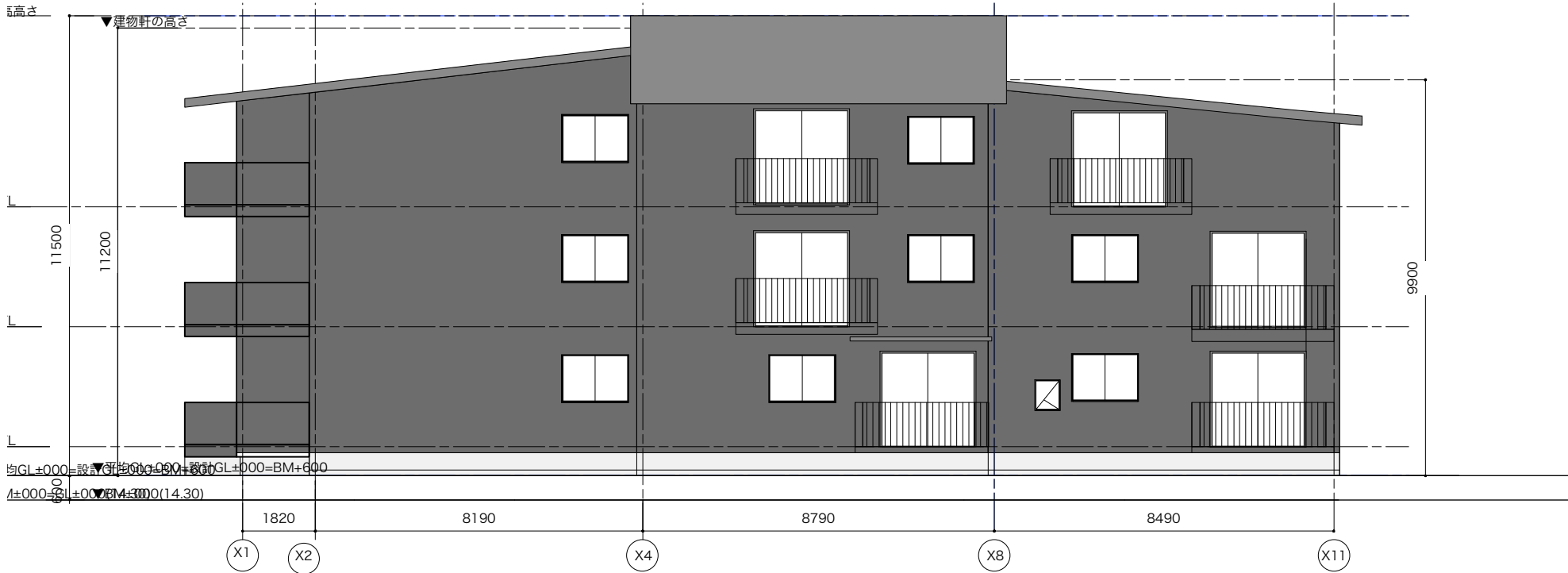
南立面図 設計GL±000=BM+600とする 平均GL±000=設計GL±000とする
