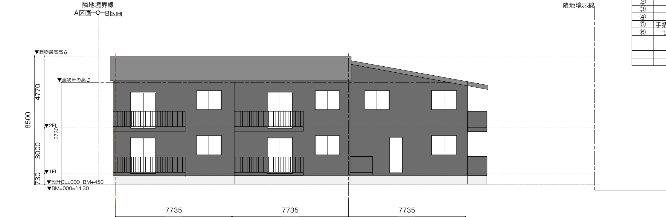
南立面図 設計GL±000=BM+450とする 平均GL±000=設計GL±000とする
