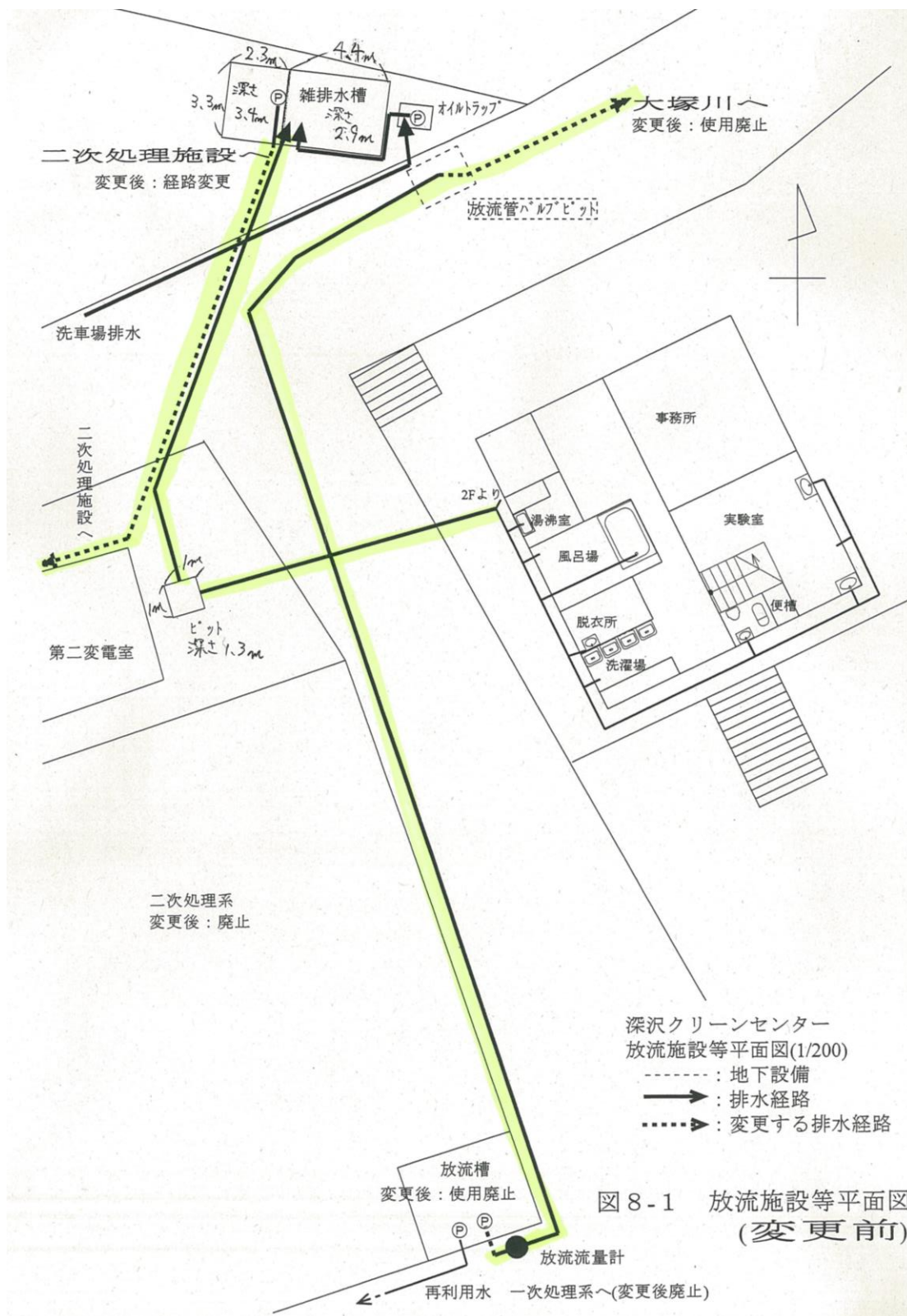
図 4.1.2(1) 事務所 1 階実験室から放流先までの排水経路 (不明～平成 11 年)
