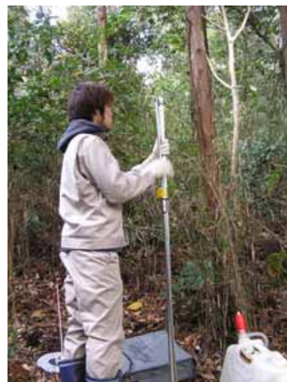
長谷川式土壌貫入計による土壌硬度の鉛直変化の測定
