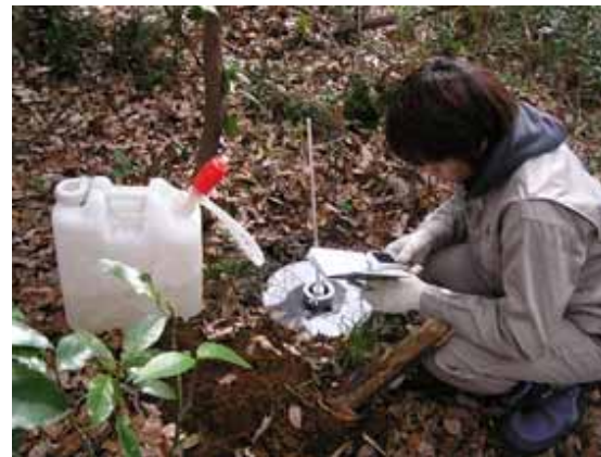
長谷川式現場透水試験による透水性の測定
