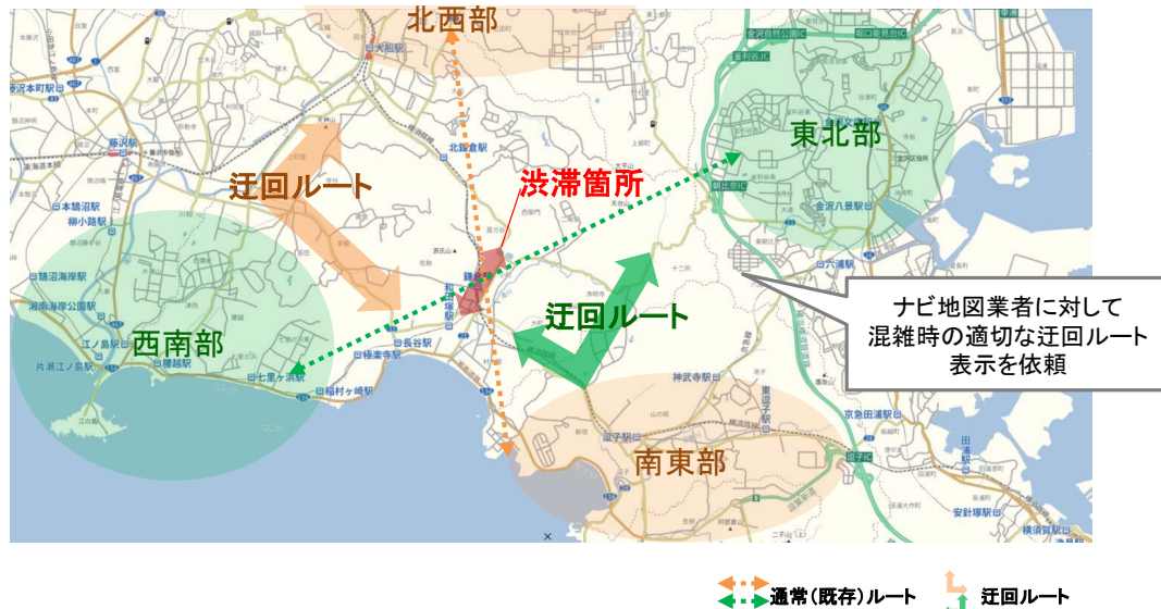
図4-2 八幡宮前交差点を通過する交通の迂回ルートの提示イメージ
