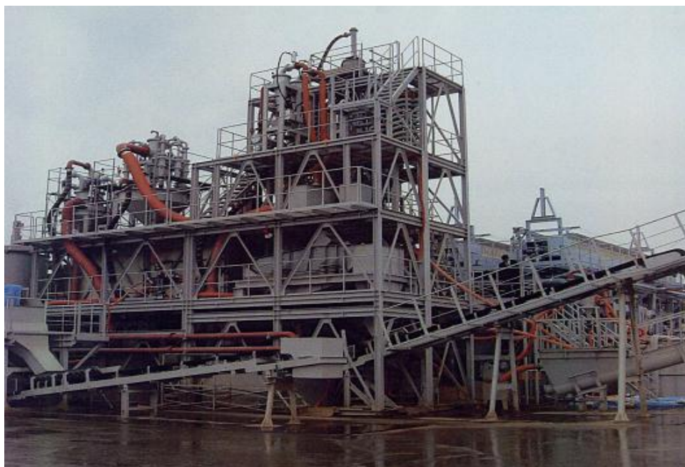
清水建設 土壌汚染浄化プラント例
