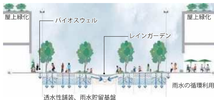
レインガーデン（雨庭）： 降雨時に雨水を一時的に貯留し、時間をかけて地下へ浸透させる透水型の植栽スペース
