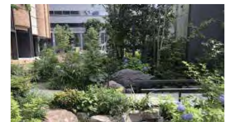
レインガーデン (雨庭): 降雨時に雨水を一時的に貯留し、時間をかけて地下へ浸透させる透水型の植栽スペース
