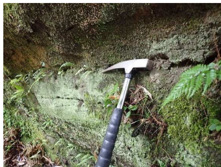
露頭(1)拡大図 表面軟質化
