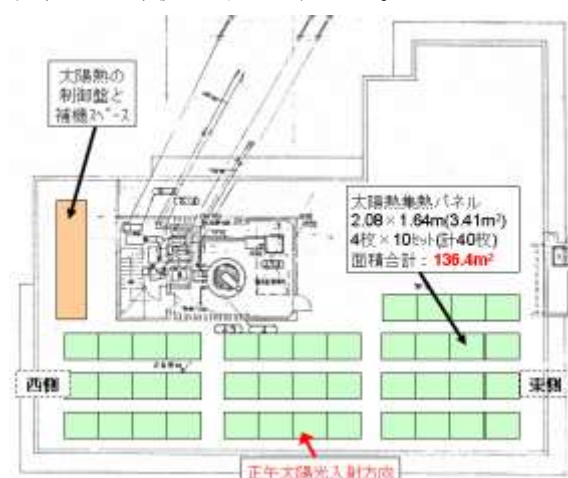
図 7.4.3-3B 太陽熱パネル設置（図書館）
