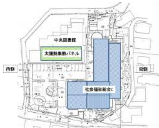
図 7.4.3-3F 中央図書館パネル設置場所
