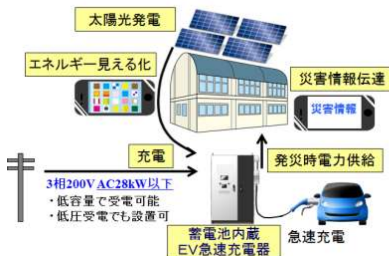
図 7.3-5 ミニ防災拠点の電力供給の安定化提案
