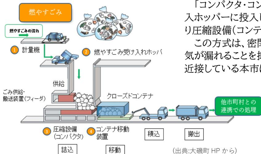
「コンパクト・コンテナ方式」は、燃やすごみを収集車から受入ホッパーに投入し、投入されたごみは、供給・搬送装置により圧縮設備(コンテナ)に送りこまれます。
