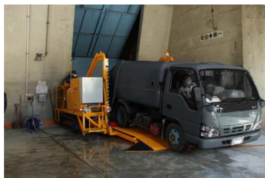
自走式コンベア ごみ投入検査機
